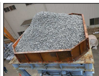
写真4 バラスト積状況(40m 3 )
