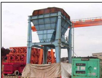
写真2 大型ホッパー(既製品)
