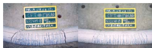
写真-5 CFTとRCFTの曲げ試験体
