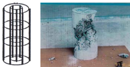
写真-4 中央配筋、せん断破壊した試験体、せん断補強筋
