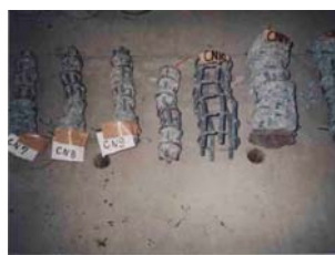
写真-4 中央配筋、せん断破壊した試験体、せん断補強筋
