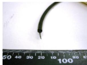
図1 光ファイバケーブルセンサ
