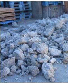
写真-1 コンクリートがら
