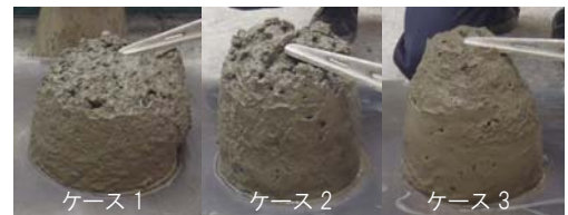
写真-1 スランブの状況
