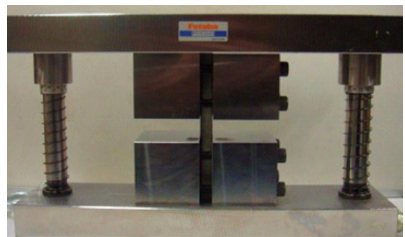
写真-1 圧縮試験のセットアップ状況
