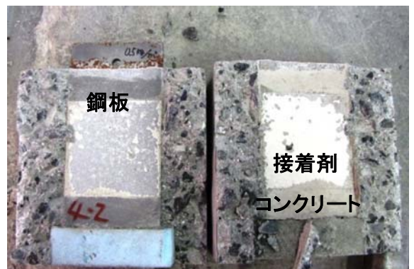
写真-2 付着状況（接着剤膜厚 0.5\text{kg/m}^2 ）
