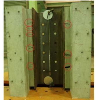
写真-2 NR3-W30 実験後の破壊性状
