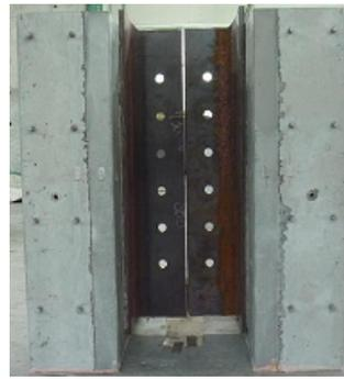
写真-1 NR3-W60 実験後の破壊性状
