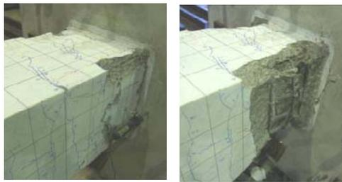
(a) 3δy-3回目 (M点) (b) 4δy-3回目 (繰返しにより荷重低下)
