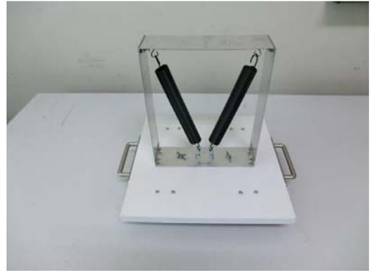
写真-1 耐震補強用ばねを装着した建物模型と振動台
