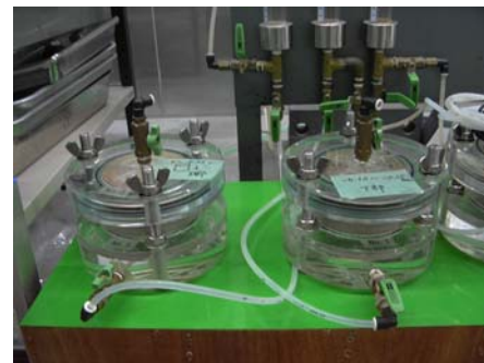
写真-4 透水試験状況
