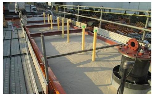
写真 1 大型土槽の状況(手前がバキュームディープウェル)
