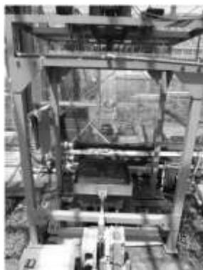
写真-1 人工降雨装置
