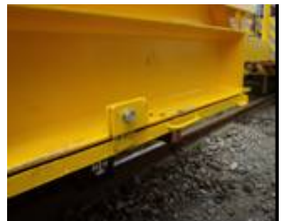
写真-9 バラスト落下防止板
