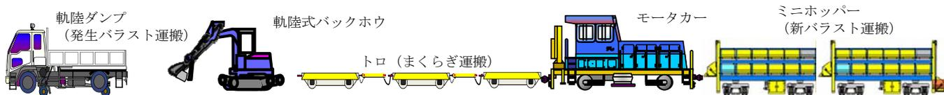
図5 道床・まくらぎ同時更換時の保守用車配置
