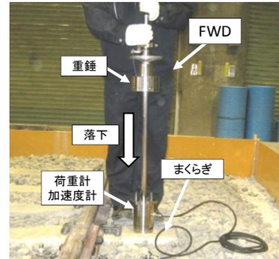
図 1 FWD を用いた軌道支持剛性測定試験の状況
