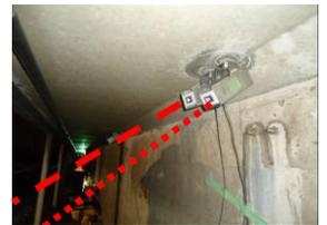
写真-6 沈下量計測
