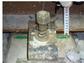
写真-5 沈下量確認
