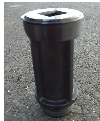
図5 完成保持ボルト孔キャップ外観
