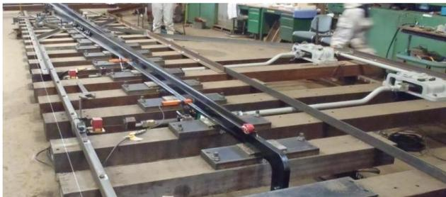
図4 転換試験の状況
