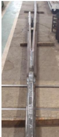
今回試作した可動レールは、将来の保守の省力化等を考慮してクロッシング構を省略し、直線側と分岐線側の両方のレールに弾性部を設けている。以下の静的解析および転換試験では、分岐線側後端部を座金等で固定して可動レールを弾性変形させる条件と、伸縮構造を想定して分岐線側をふく進させる条件の2通りで検討した。
