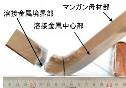
図3 破断した供試体
