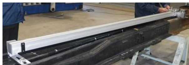
図4 マンガンクロッシング踏面補修部の仕上り測定器
