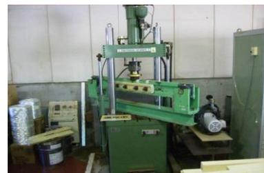
図-5 繰返し荷重試験装置
