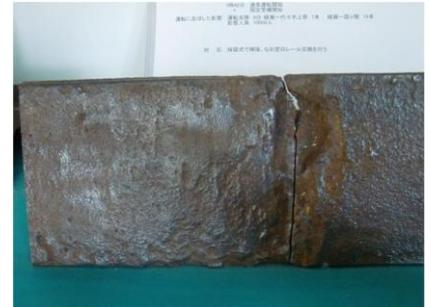
写真1 底部電食による折損
