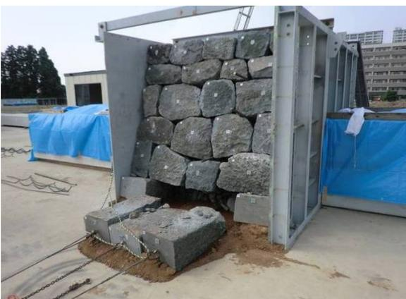
写真-3 効果確認実験 (石材引き抜き後)
