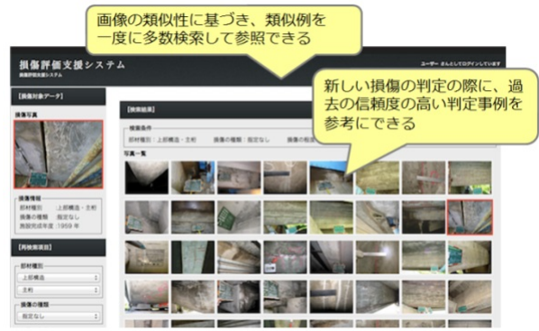
図3 損傷評価支援システム
