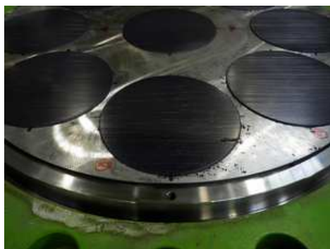
写真-1 載荷後のすべり材状況
