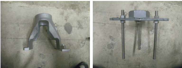
図－2 付着試験器固定部の改良
