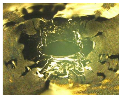
図 3 CSM①で生じたクラック
