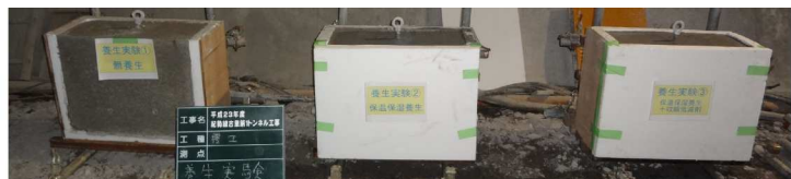
写真-2 比較供試体 養生状況
