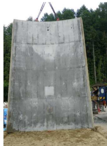
写真-3 脱型後供試体(下面)
