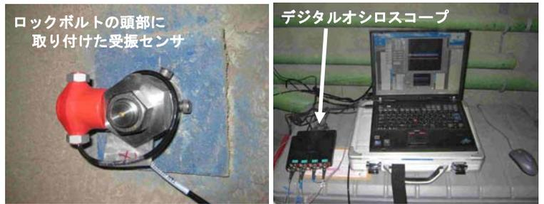
図-3 受振センサの設置状況と測定状況
