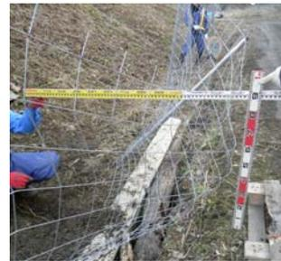
図4 落石を捕捉できなかった時の簡易柵の状態
