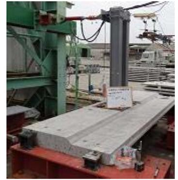
写真-7 水平載荷試験状況
