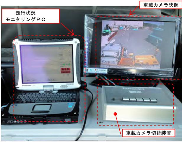
写真-2 先導車内の自律走行確認状況
