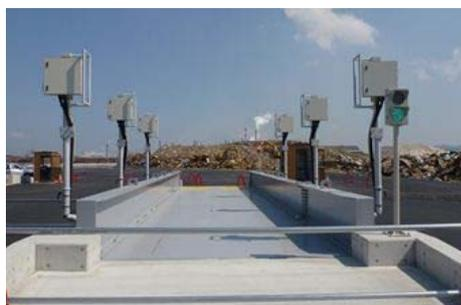
図-2 計測器設置状況(コンテナ車用)
