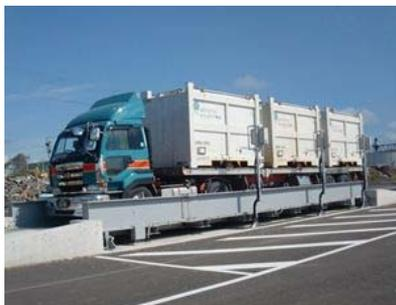
図-4 コンテナ車計測状況
