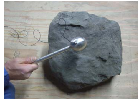
写真-1 探査状況 (泥岩：研磨なし)
