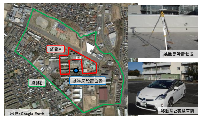
図-1 各走行コースと受信機設置状況
