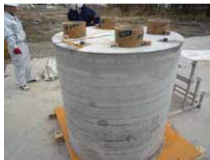
写真 - 4 破砕前の試験体
