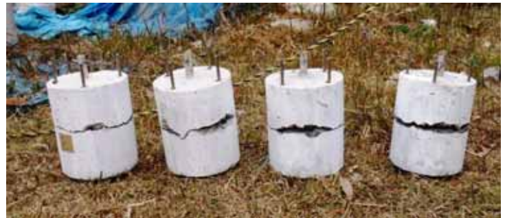
写真 - 3 コンクリート破砕薬を使用したモデル実験 における水平破断面の形成状態
