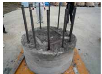
写真 - 7 平滑な水平破断面
