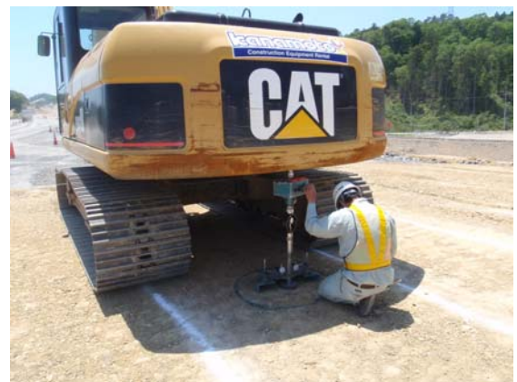
写真2 現場 CBR 試験の実施状況
