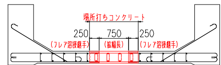
図-3 配筋図(拡幅後・支間部)
