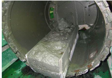
写真-6 切断回収した杭
