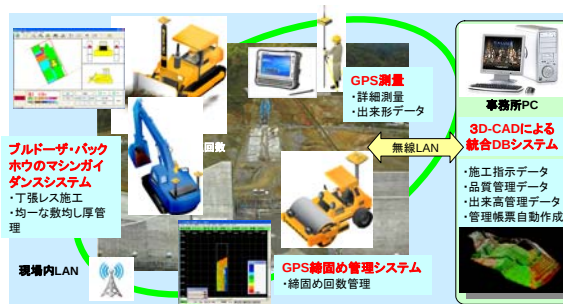
図-1 ICT 土工管理システム概要図
