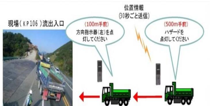
図-3 注意喚起システムの概念図
