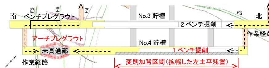
図-5 No.4 貯槽 アーチおよびベンチ掘削時の作業経路と作業状況
