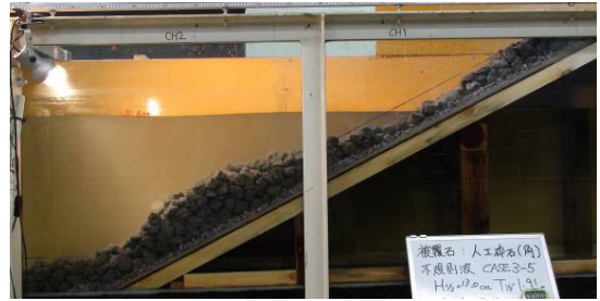
写真-2 人工石の被災状況 (角型, T_{1/3}=1.91s , H_{1/3}=0.13m )
