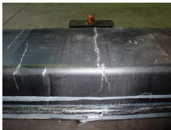
図-5 単体 FRP 矢板最終破断状況
