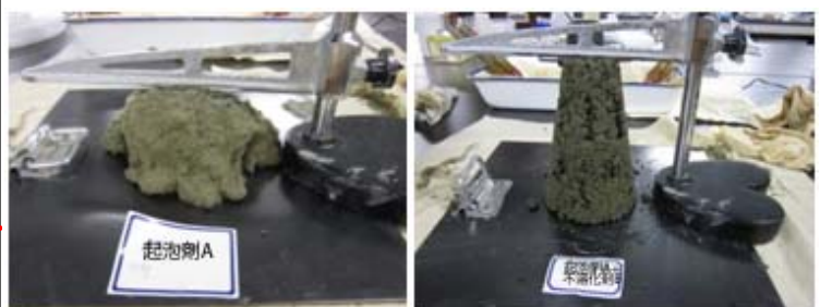
写真-1 不溶化剤添加によるミニスランプ試験
