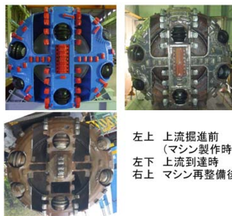
写真-1 カッターフェイス状況
