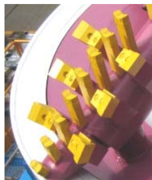
写真－4 再利用ビット取付状況
