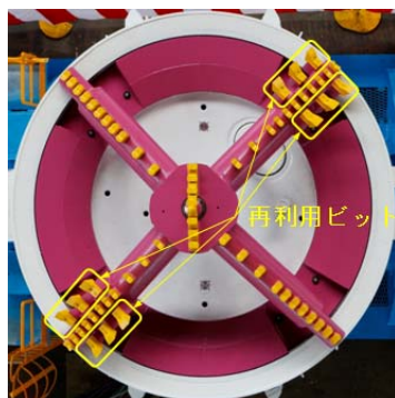
写真－5 掘進前面板状況
