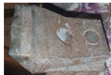
写真－6 掘進後の再利用ビット状況
