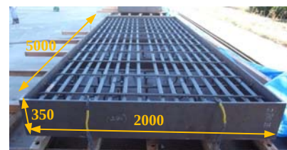
写真-1 平板単体曲げ試験体 (コンクリート打設前)
