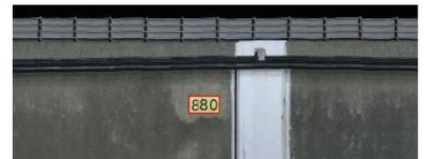
図7 パターンマッチングによるキロ程銘板の検出結果
